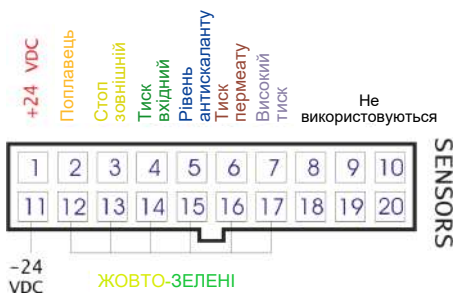
Рисунок 2. Входи ОС6000 — роз’єм дискретних входів SENSORS
