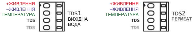
Рисунок 4. Входи ОС6000 — роз'єми для комбінованих датчиків електропровідності й температури TDS1 і TDS2
