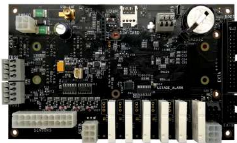
Рисунок 30. Роз'єм під'єднання акумулятора на платі контролера ОС6000
