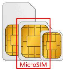
Рисунок 22. Потрібний типорозмір SIM-карти — MicroSIM
